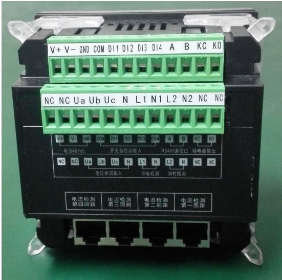
图 1 三相多功能多回路网络测控仪表实物图 典型仪器 2：电量监测单元（型号: SL-A(3)/A21）
