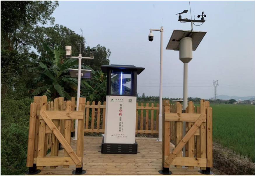
图 1. 智慧农业物联网预警监测站
