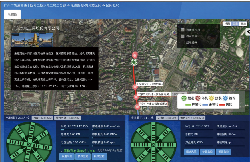
图 4. 盾构施工数据分析展示
