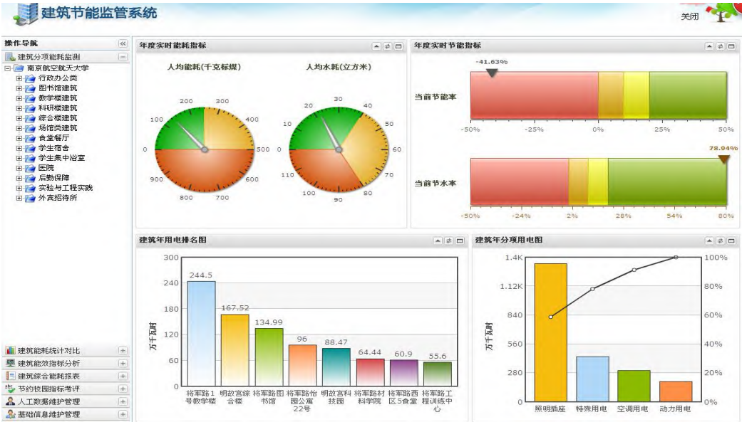
图 3.8.2.1 建筑节能监管系统软主页面
