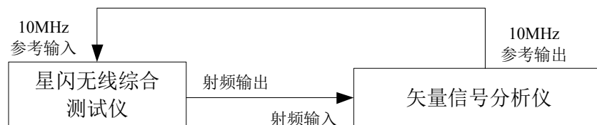
图 5 星闪发射信号调制质量校准
