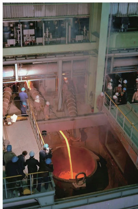
第一炉铜水正从闪速炉中流出
