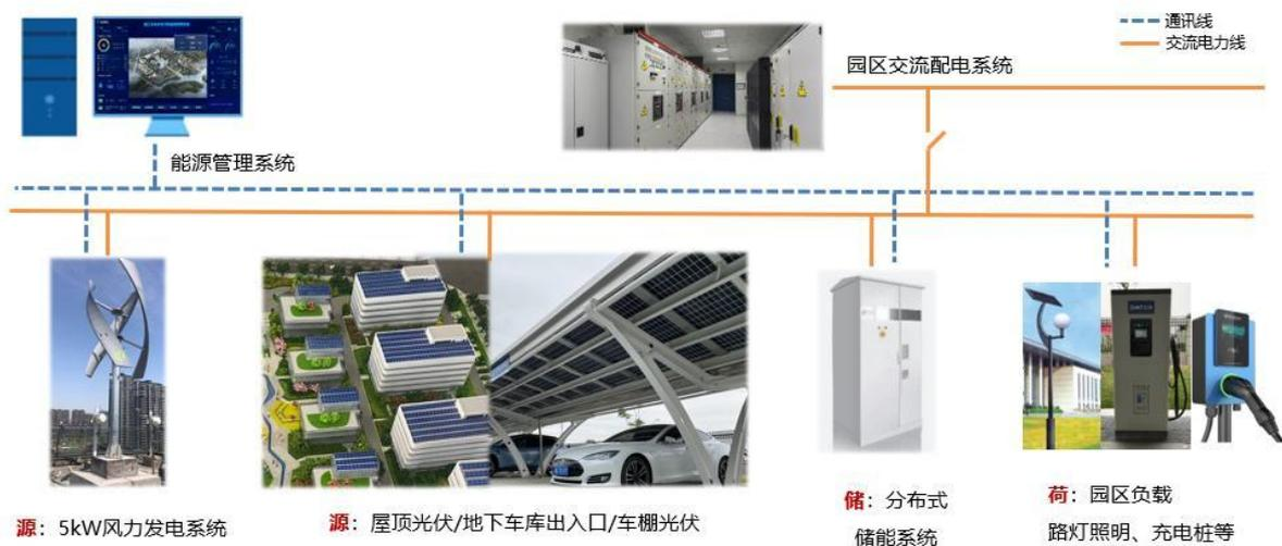
图 3-13 某产业园源网荷储协同项目
