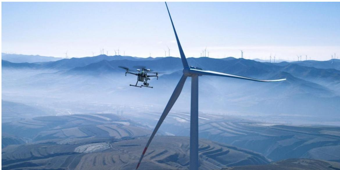
图 3-8 风电无人机巡检工作
