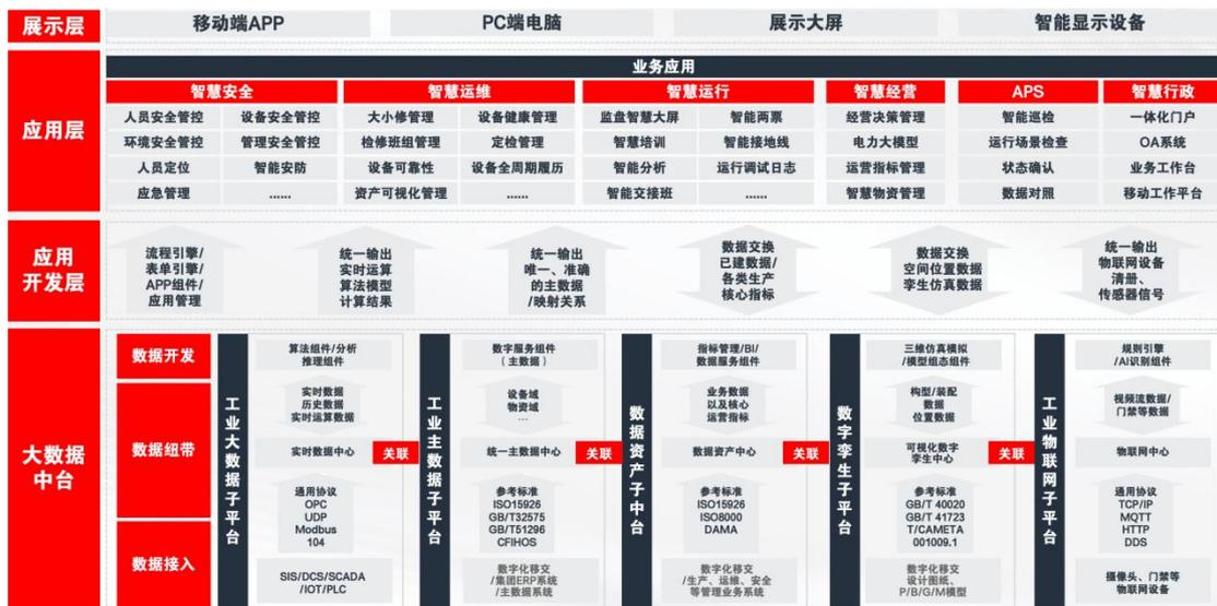
附图 1-10 数字孪生智慧电厂服务体系架构图
