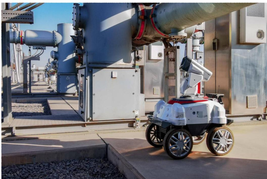
图 3-11 某变电站机器人巡检
