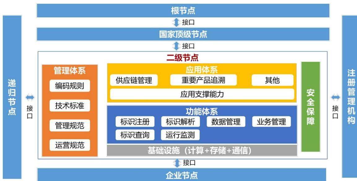
图 5-5 行业层工业互联网标识总体架构图
