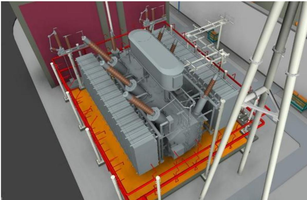
图 3-2 主变压器三维模型
