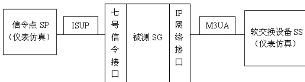
图 4.2.1 信令网关功能测试配置图
