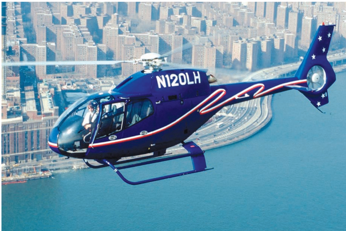
图11 中国、法国和新加坡联合研制的EC120 2t级多用途轻型直升机
