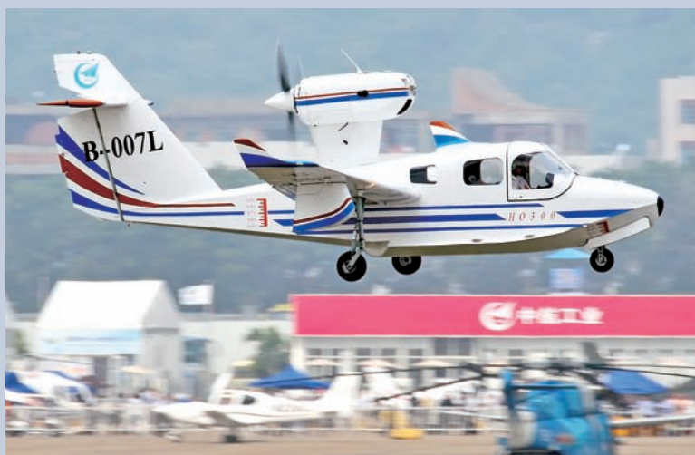
图8 海鸥300 4~6座轻型水陆两栖飞机
