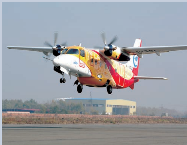
图5 运—12F 19座涡桨多用途通用飞机
