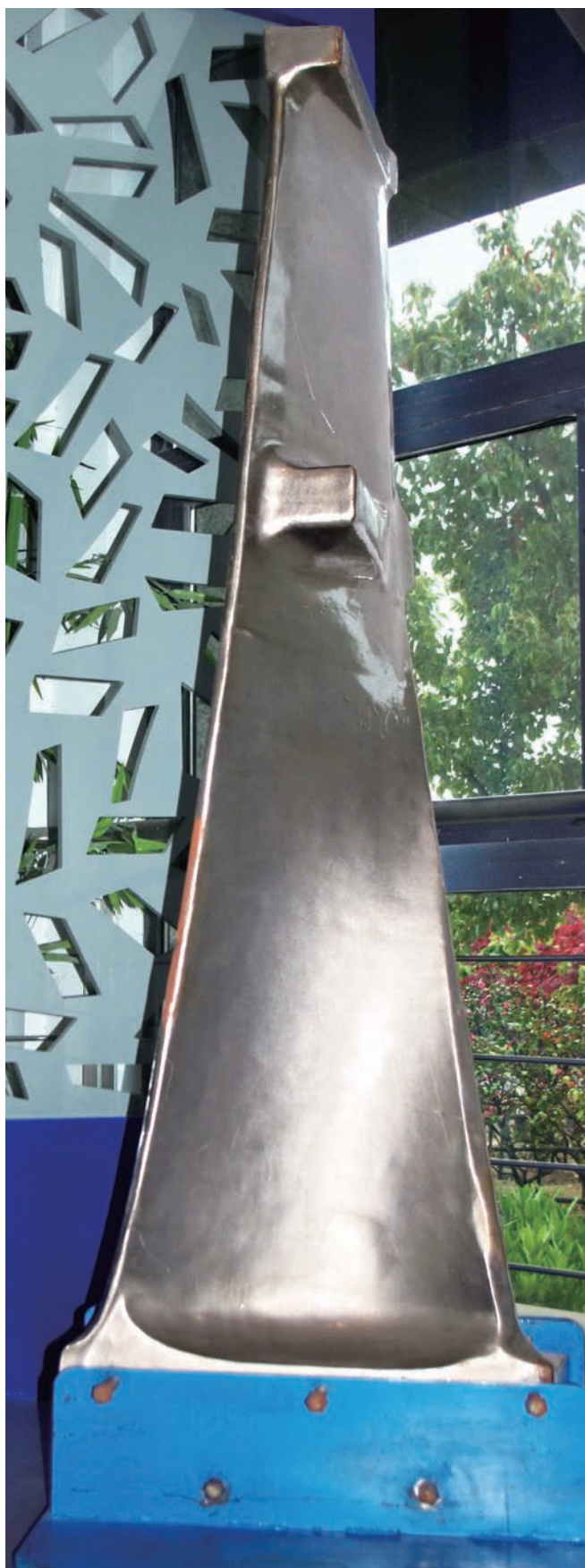
图29 WTB研制的第三代技术CAP1400（1700）常规岛半转速大容量汽轮机1.83m（72英寸）末级长叶片
