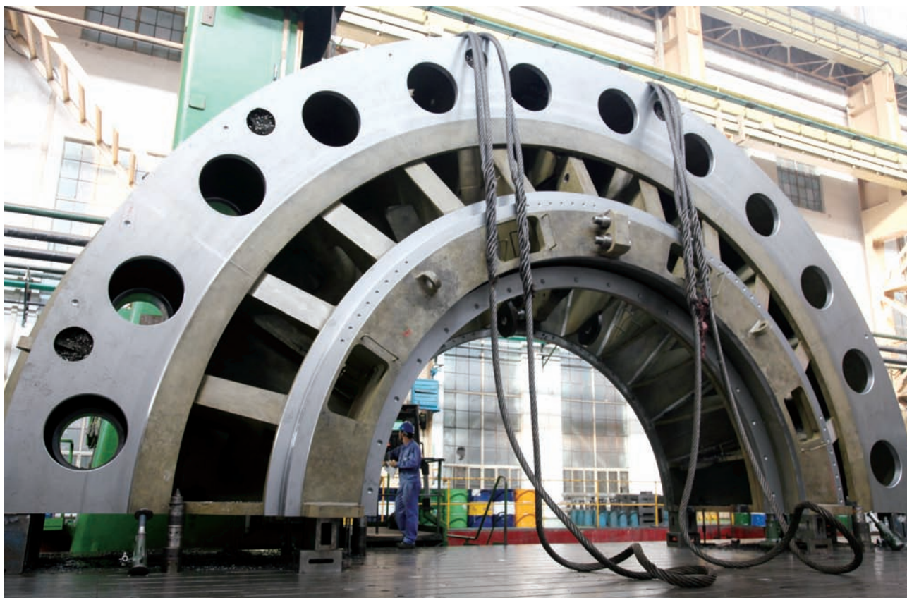
图17 哈电自主研发的向家坝800MW水电机组机顶盖
