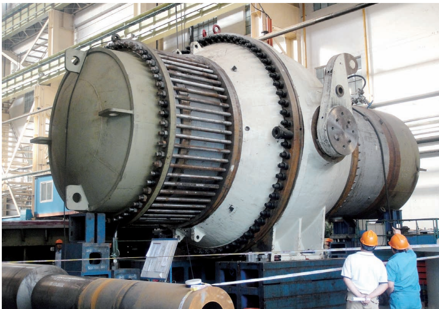
图20 哈电研制的响水涧水电站250MW抽水蓄能机组首台球阀在验收试验中
