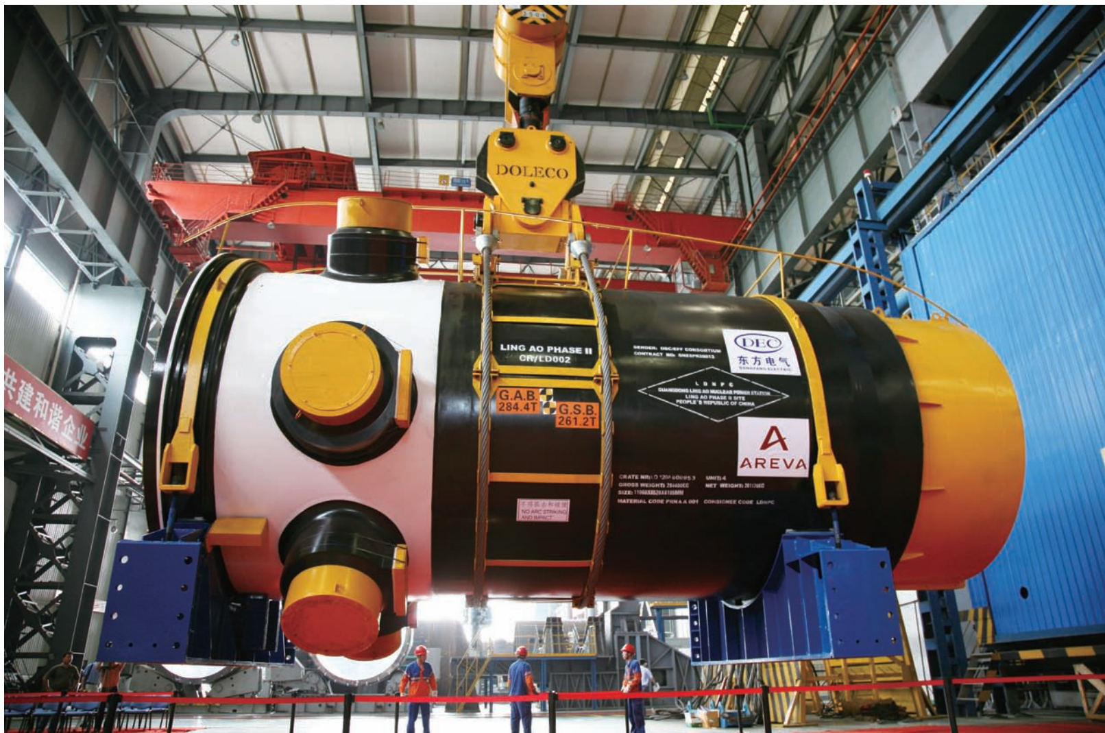
图24 中国首台1000MW级核电站反应堆压力容器在东电制造完成
