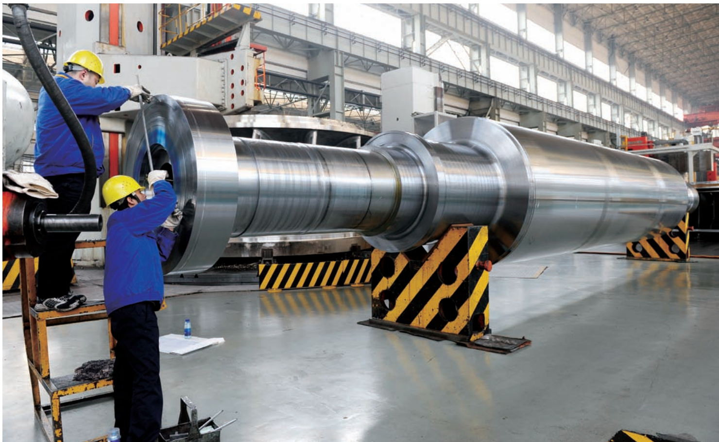
图25 宁德核电站1150MW核能发电机转子在东电制造
