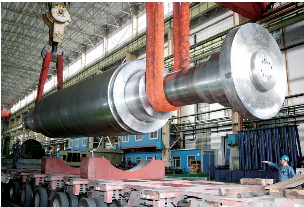
图27 哈电研制的三门核电站发电机转子正在吊运
